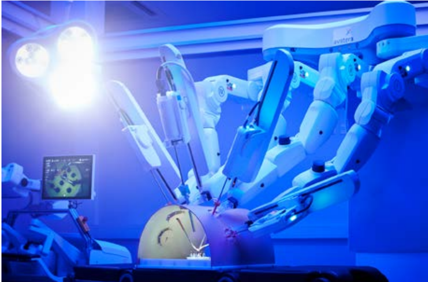
Im avatera-Trainingszentrum: der OP-Roboter überträgt die Handbewegungen des Chirurgen präzise und zitterfrei auf die laparoskopischen Instrumente. Bildquelle: avateramedical
